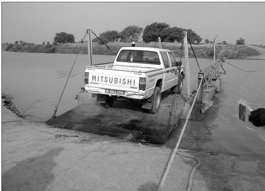
Fig. 10 – *Una chiatta a sistema manuale sul fiume Gayo*
